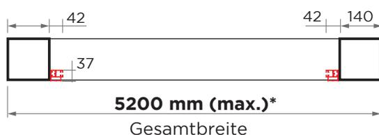
\*Bei größerer Breite: einen Zwischenpfosten hinzufügen
