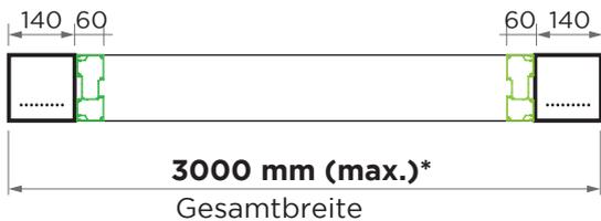
\*Bei größerer Breite: einen Zwischenpfosten hinzufügen
