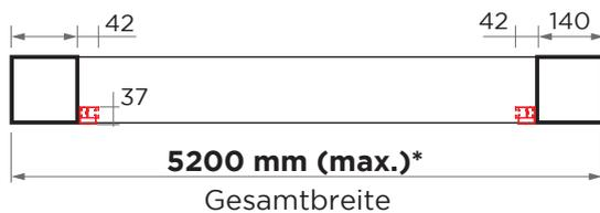
\*Bei größerer Breite: einen Zwischenpfosten hinzufügen
